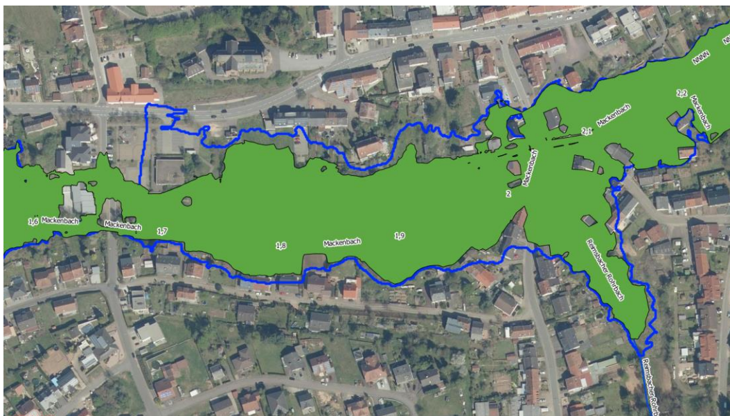
Abbildung 19: Vergleich Überflutungsausdehnung HQ100 HWGK (1D, blau) mit HQ100 2D-Modell (grün)
